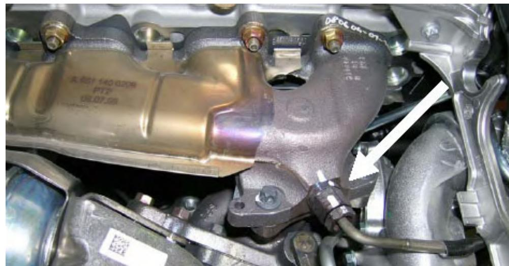
Sonda térmica para os gases de escape
